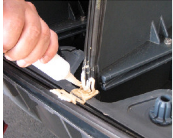
8. A tömítőpasztát a válaszfal és a tartály tömítése között el kell osztani.
