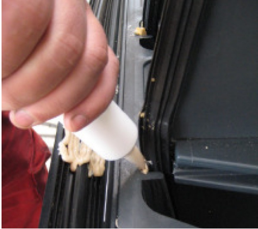
7. A tömítőpasztát a válaszfal tömítés és barázdáiba és a tartály és a tömítés közötti üregbe is be kell nyomni.
